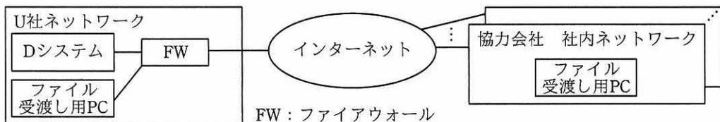
図 1 D システムに関する機器の全体構成
