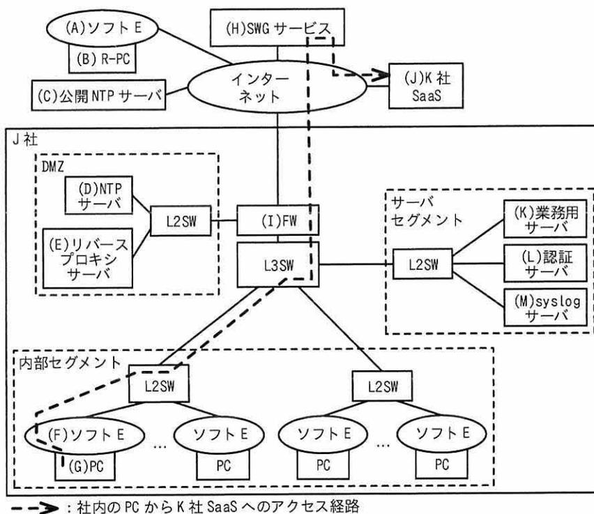
図 2 SWG サービス導入時のネットワーク構成
