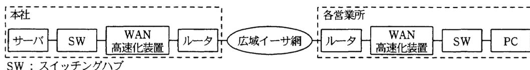
図 3 WAN 高速化装置の接続方式
