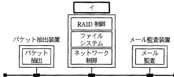
図3 モニタ型のメール収集システム構成
