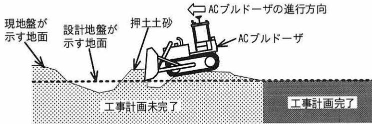
図 4 AC ブルドーザの敷均し
