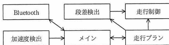
図3 制御部の主なタスク構成
