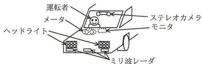
図 1 運転支援システムの制御・通知対象
