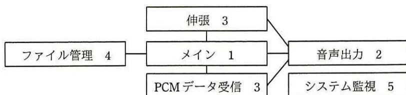
図 3 メイン MCU の主なタスク構成
