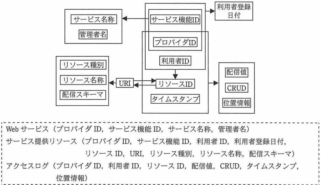
図 5 関係“Web サービス”，“サービス提供リソース”，“アクセスログ”の属性間の関数従属性
