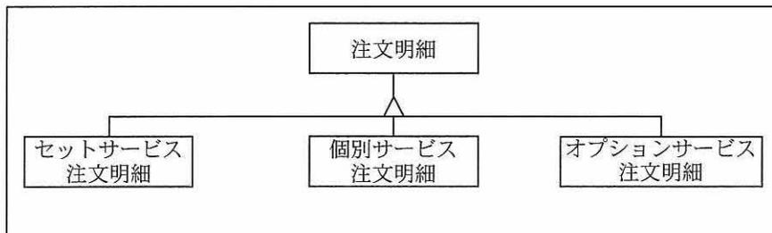
図3 注文明細のサブタイプ構造
